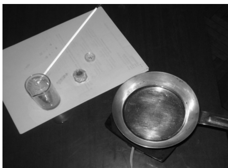
Рисунок 2.1 Установка для демонстрации ячеек Бенара
